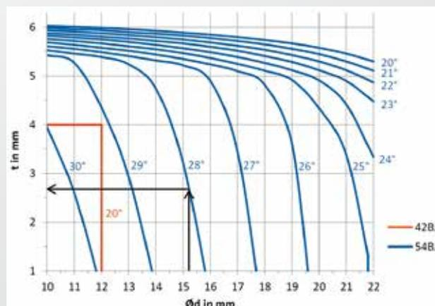
例 54BJ:  $\text{Ø}d = 15.2 \text{ mm}$ ;  $\alpha = 28^\circ \rightarrow t \leq 2.7 \text{ mm}$
